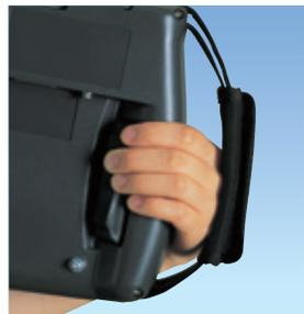
押しやすい3ポジションイネーブルスイッチで手軽な操作と安全性を確保。
